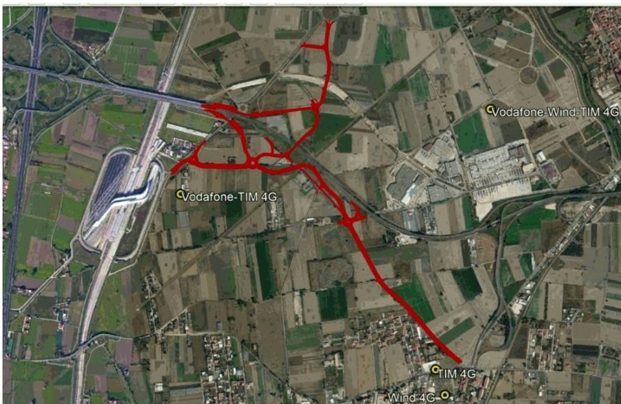
Figura 6-10 Stralcio planimetrico con indicazione delle vicine SRB (tracciato di progetto in rosso)
