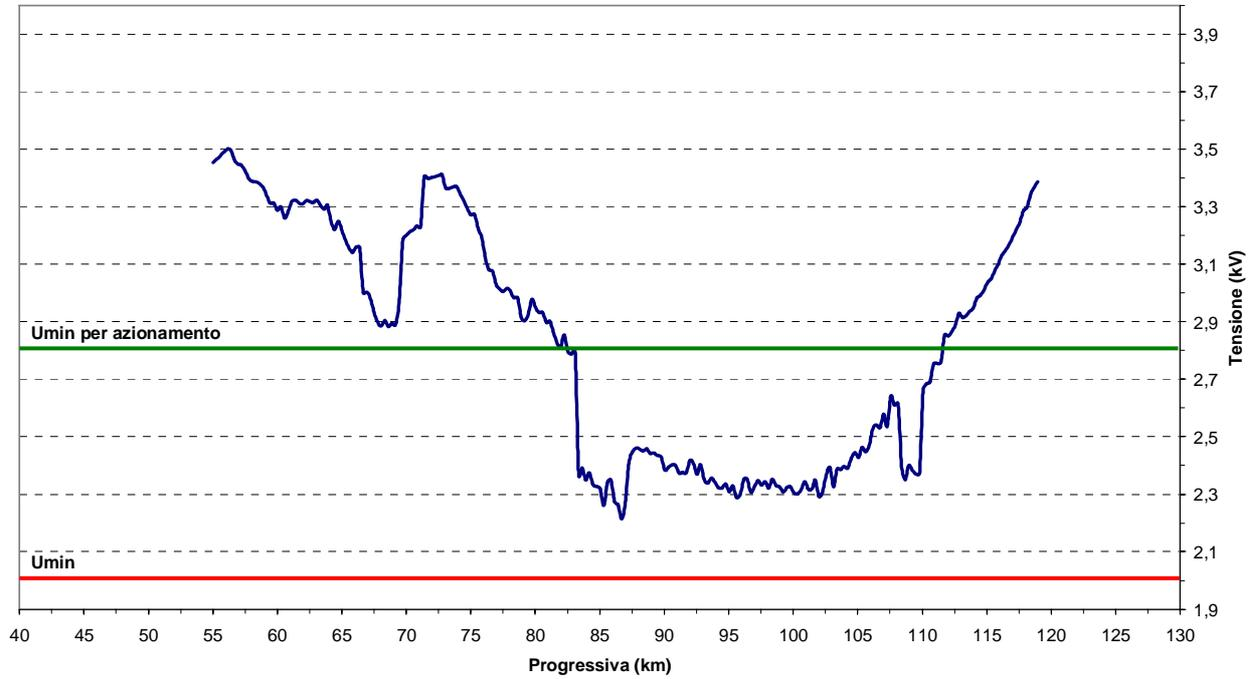
**Figura 7 Treno su linea storica con cabina TE senza nuove SSE e con il fuori servizio delle SSE di Trento**
