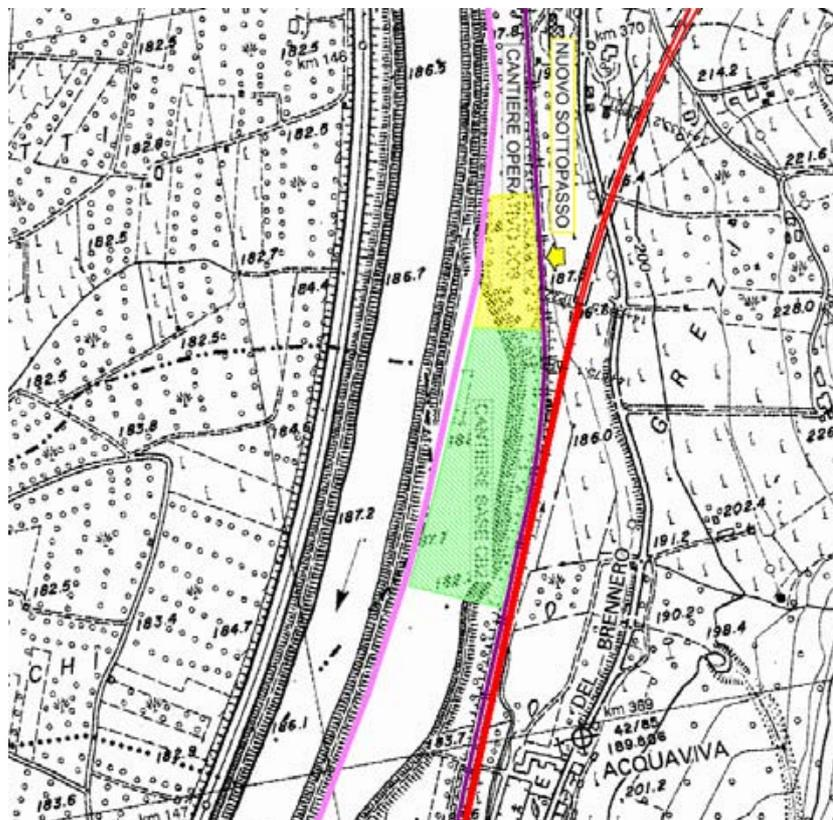
Figura 11. Stralcio della tavola ACTP-11[1].04.00-08V1R2. In evidenza il cantiere base CB2 (in verde) e il cantiere operativo CO3 (in giallo) che coprono rispettivamente 1,1 ha e 3,8 ha in località Acquaviva.
