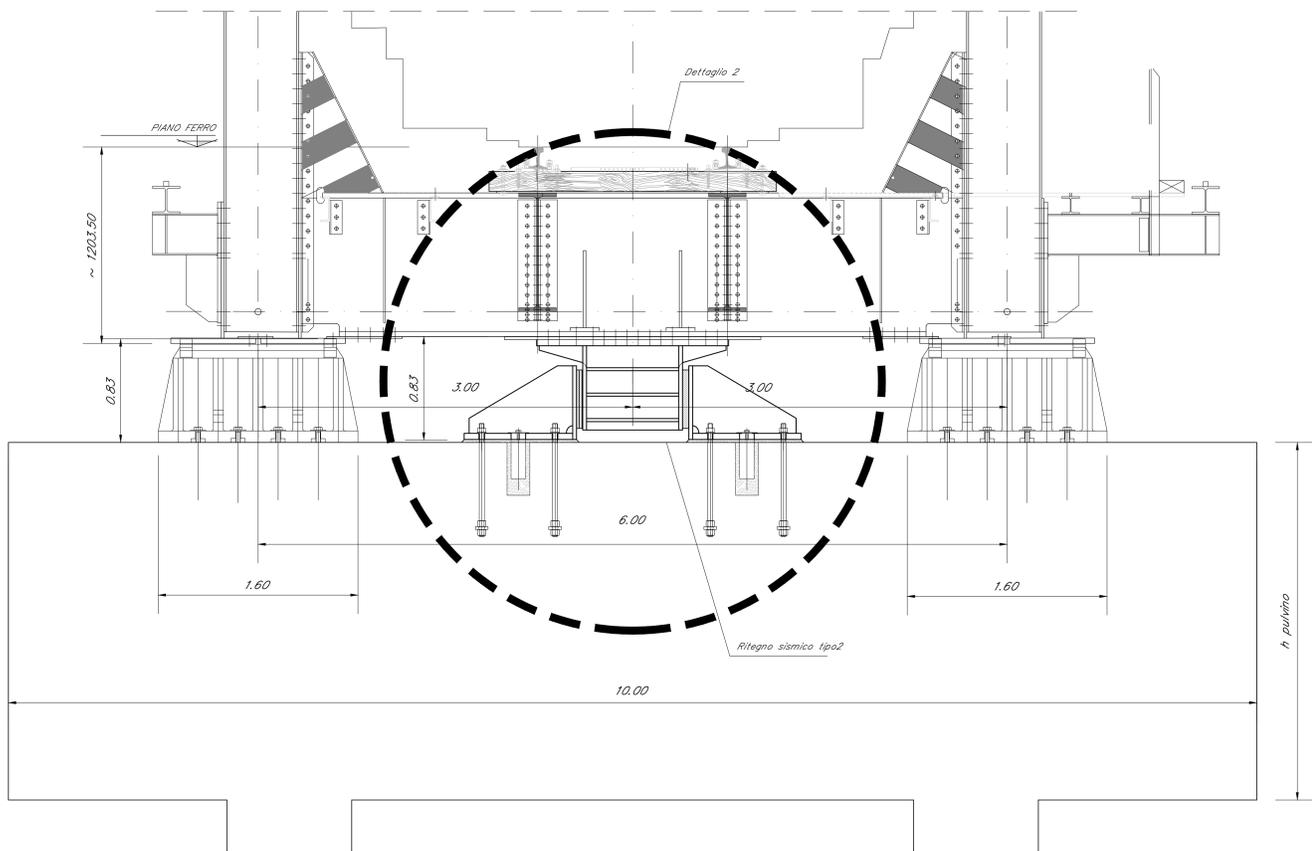
DETTAGLIO - RITEGNO SISMICO TIPO 2
