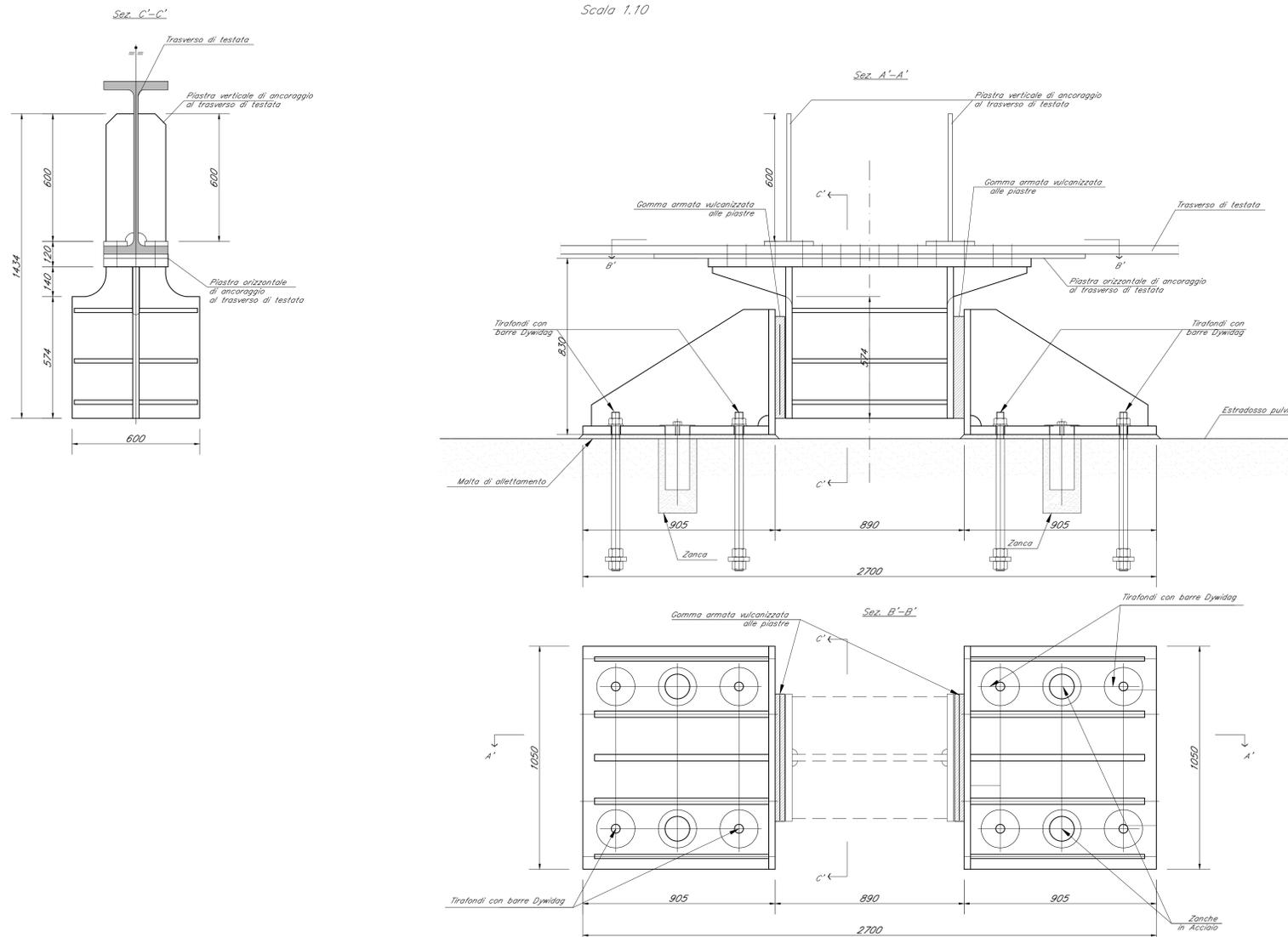
DETTAGLIO - RITEGNO SISMICO TIPO 1
