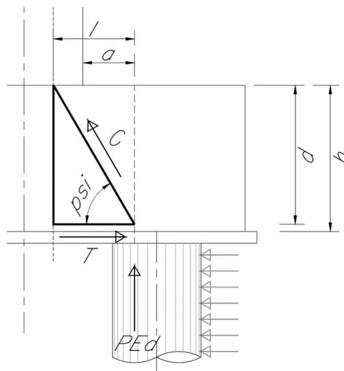
Figura 15: Schema – Biella compressa di calcestruzzo  $C$  e tirante di armatura  $T$
