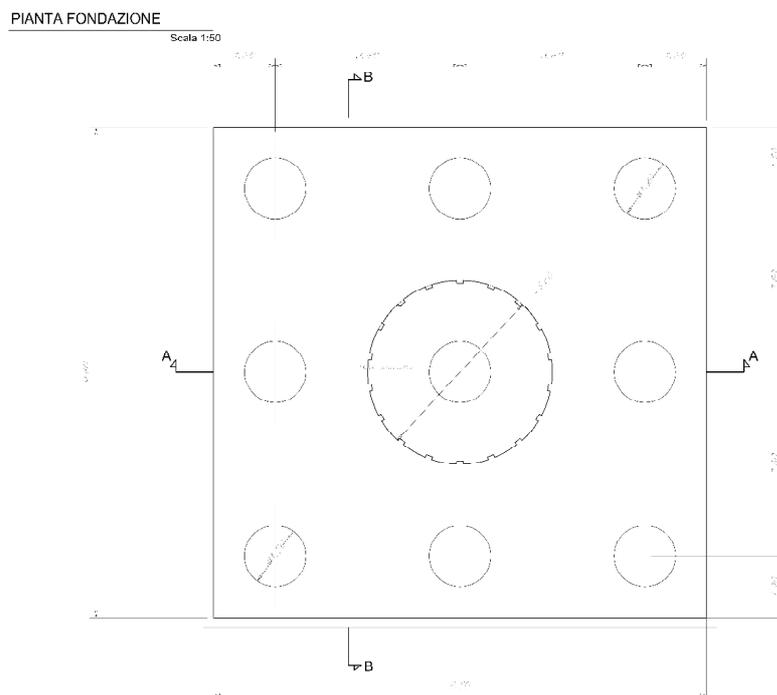
Figura 16: Sezione Tipo plinto di fondazione
