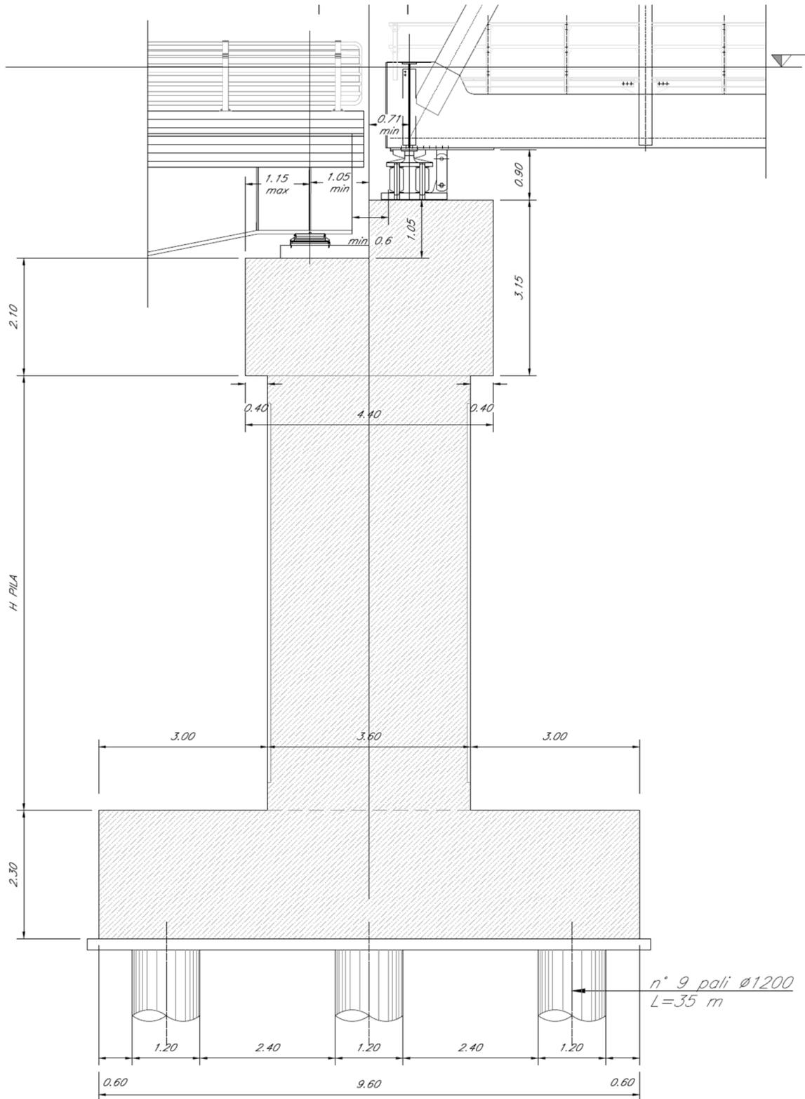
Figura 3: Sezione longitudinale
