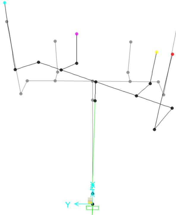
Figura 9: Deformata terzo modo di vibrare
