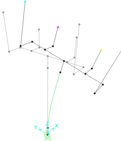
Figura 7: Deformata primo modo di vibrare
