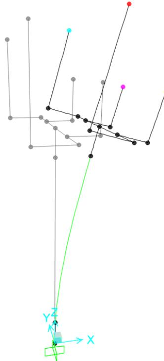
Figura 8: Deformata secondo modo di vibrare
