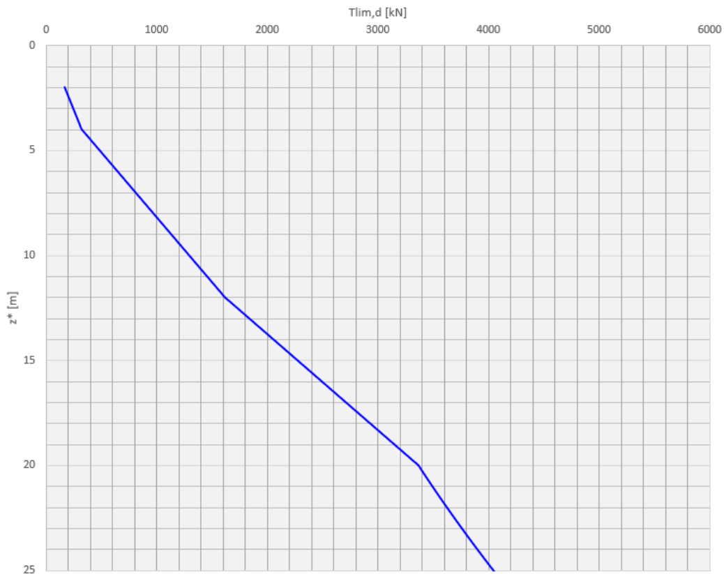
Figura 16: carico limite verticale in trazione per un palo delle spalle del VII5.
