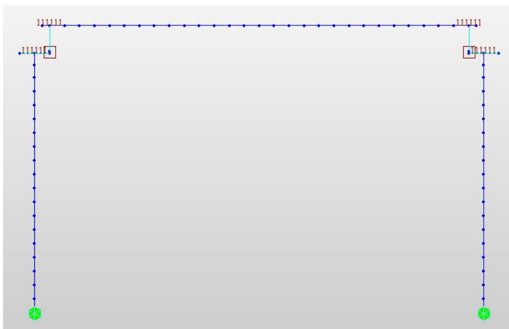
Figura 5.6 – Modello semplificato per la valutazione del massimo scorrimento nell'appoggio mobile
