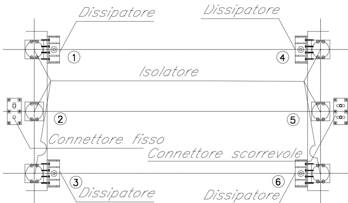
Figura 4.7 – Schema di vincoli impalcato-sottostrutture post operam
