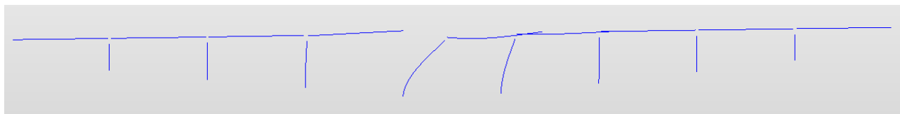
Figura 5.2 – Deformata del primo modo di vibrare del viadotto ( T = 0.554 \text{ sec} )
