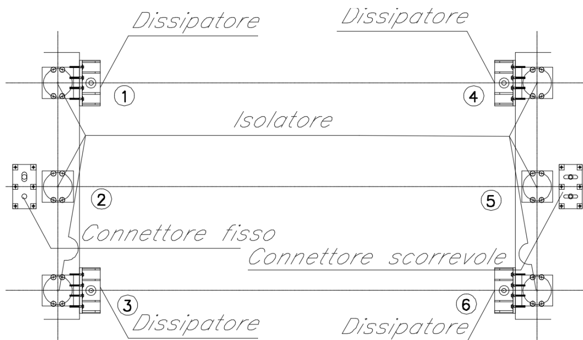
Figura 4.7 – Schema di vincolo impalcato-sottostrutture post operam
