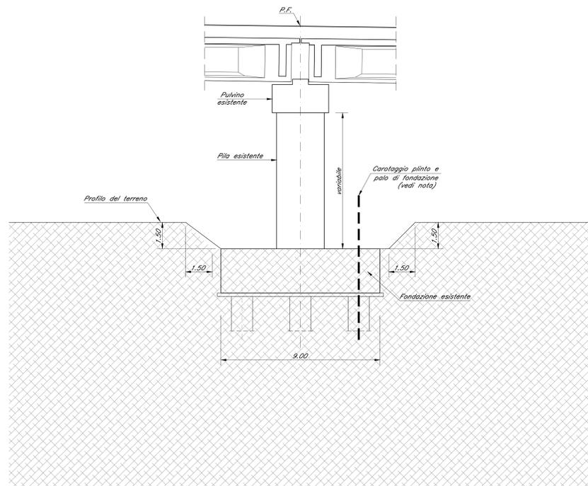
SEZIONE LONGITUDINALE PILA A 8 PALI
