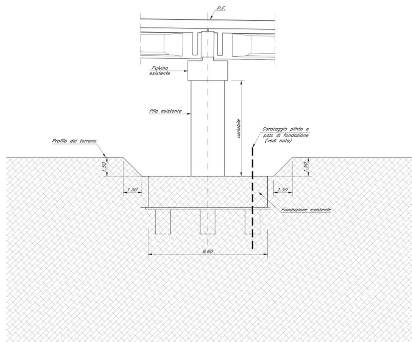
SEZIONE LONGITUDINALE PILA A 9 PALI
