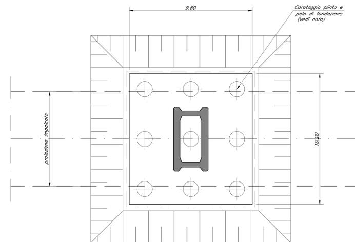
SEZIONE LONGITUDINALE PILA A 9 PALI
