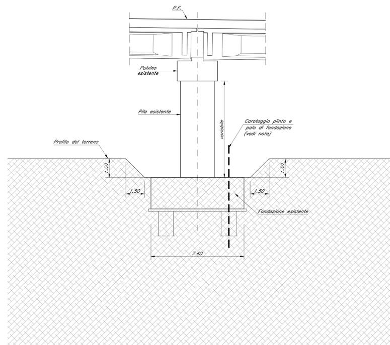
SEZIONE LONGITUDINALE PILA A 6 PALI
