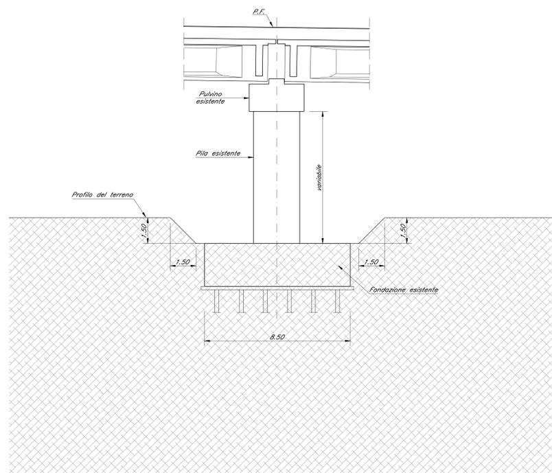
SEZIONE LONGITUDINALE PILA A FONDAZIONE DIRETTA 8.50mx12.00m
