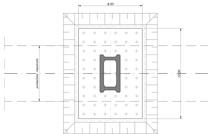
PIANTA SCAVI PILA A FONDAZIONE DIRETTA 8.50mx12.00m
