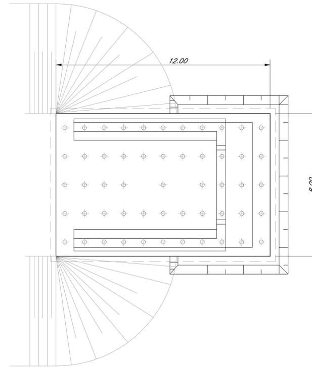
SEZIONE LONGITUDINALE SPALLA 12.00x8.00
