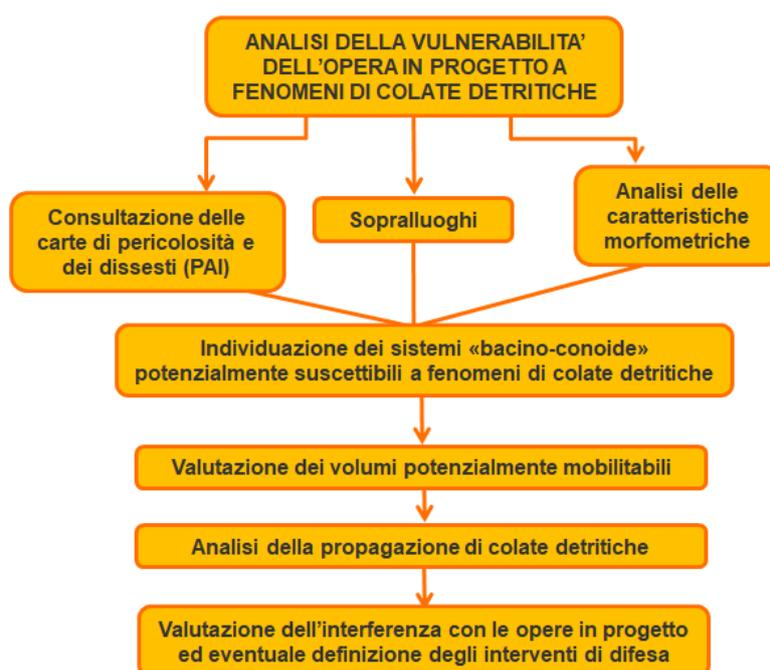
Figura 1-1: Analisi della vulnerabilità a fenomeni di colate detritiche - Flow chart.
