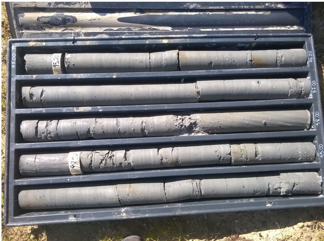
Figura 7 - Argille Subappennine (Cassetta del sondaggio S2 da 130 m)
