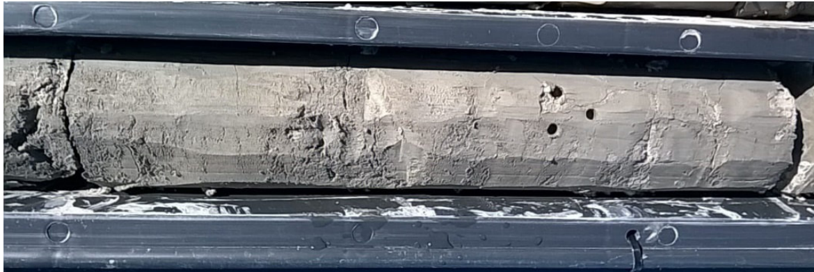
Figura 8 - Argille Subappennine – dettaglio intervalli centimetrici sabbiosi (Cassetta del sondaggio S2 da 130 m)
