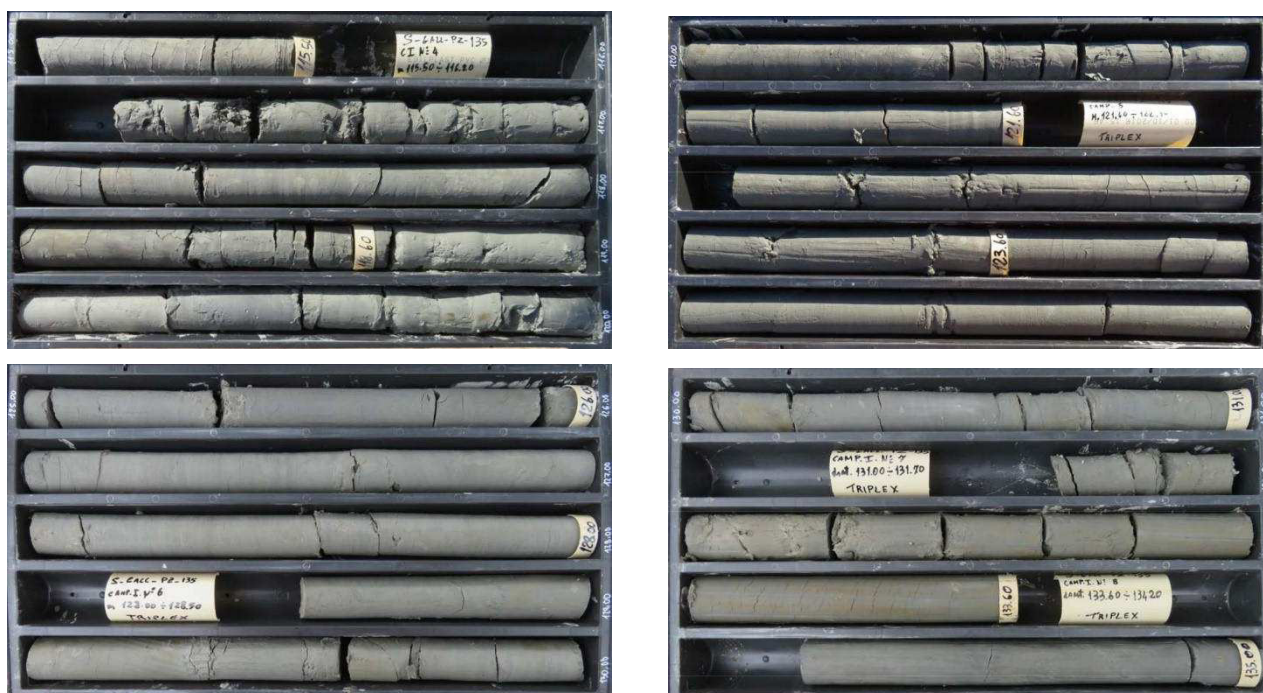
Figura 16. Foto del sondaggio S_Gall_PZ135, lungo il tracciato della Finestra, da 105 m s.p.c. a fondo foro (135 m s.p.c.) (da [4.2])
