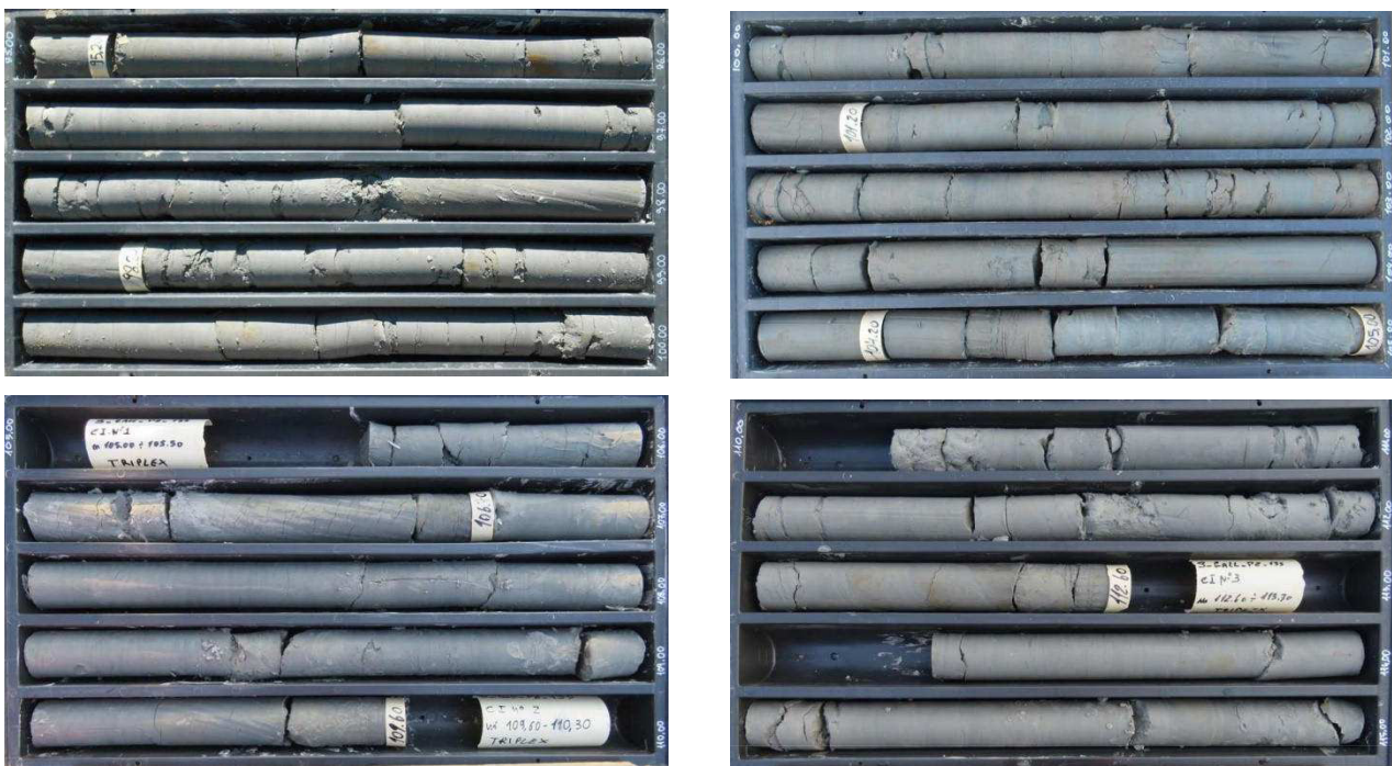
Figura 15. Foto del sondaggio S_Gall_PZ135, lungo il tracciato della Finestra, da 95 m s.p.c. a 105 m s.p.c. (da [4.2])
