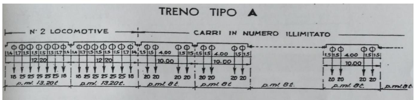
Il sovraccarico ferroviario viene considerato distribuito all'interno del ballast con una pendenza 1 a 4, con un angolo di diffusione di  $45^\circ$  all'interno del super compattato e secondo l'angolo d'attrito del terreno nel rinterro.
