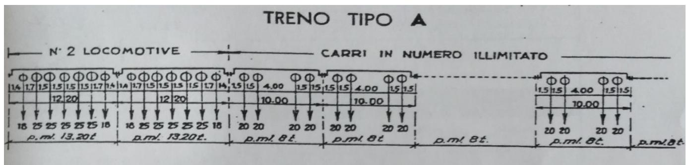
Il sovraccarico ferroviario viene considerato distribuito all'interno del ballast con una pendenza 1 a 4, con un angolo di diffusione di 45° all'interno del super compattato e secondo l'angolo d'attrito del terreno nel rinterro.
