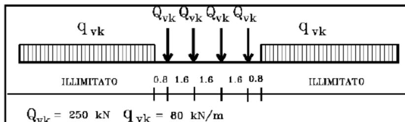
Non viene considerato l'incremento dinamico. Il sovraccarico ferroviario viene considerando distribuito all'interno del ballast con una pendenza 1 a 4, con un angolo di diffusione di 45° all'interno del super compattato e con un angolo pari all'angolo d'attrito del terreno nel terreno stesso (spessore variabile), per cui:
