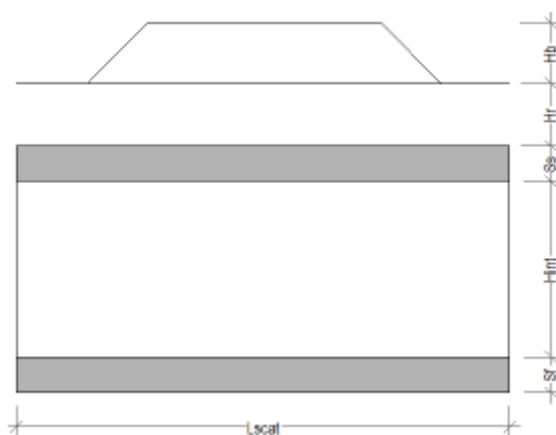
Figura 4.1 – Sezione longitudinale dello scatolare
