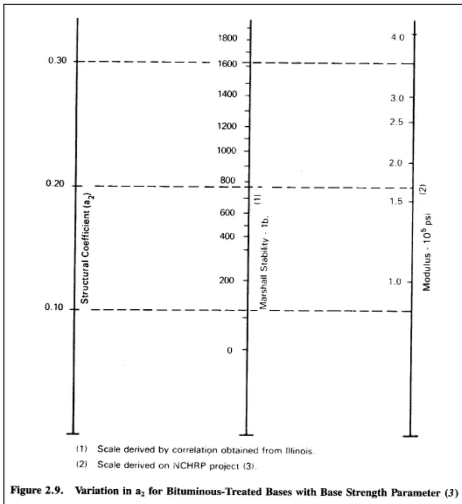
Poiché lo strato di collegamento non è previsto nella configurazione standard impiegata nell'esperimento AASHTO Guide il coefficiente  $a_2$  verrà calcolato interpolando linearmente i coefficienti dell'usura e della base.
