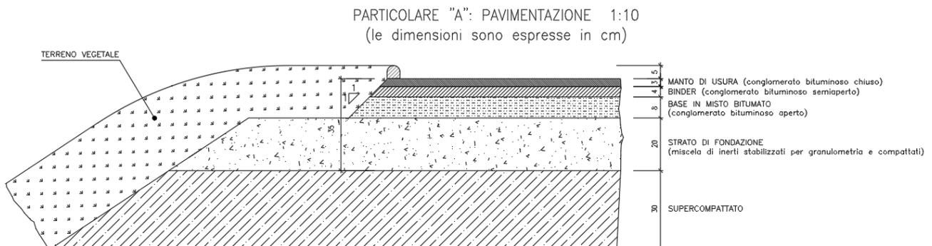
Figura 1 – Particolare pavimentazione
