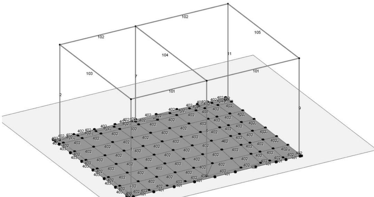
Figura 7.1-3 Modello di calcolo – numerazione frames piano fondazioni.
