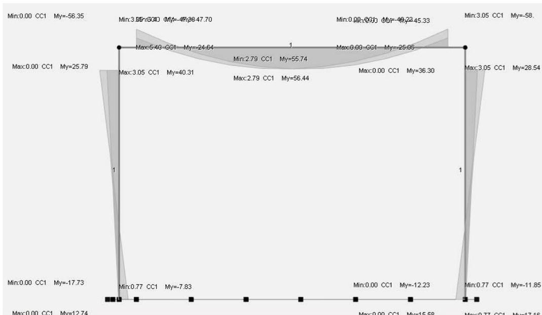
Figura 7.1-5 Diagramma dei momenti M3 - COMB\_INV\_SLV – Telaio interno
