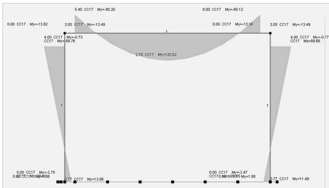
Figura 7.1-6 Diagramma dei momenti M3 - COMB\_INV\_SLU – Telaio interno
