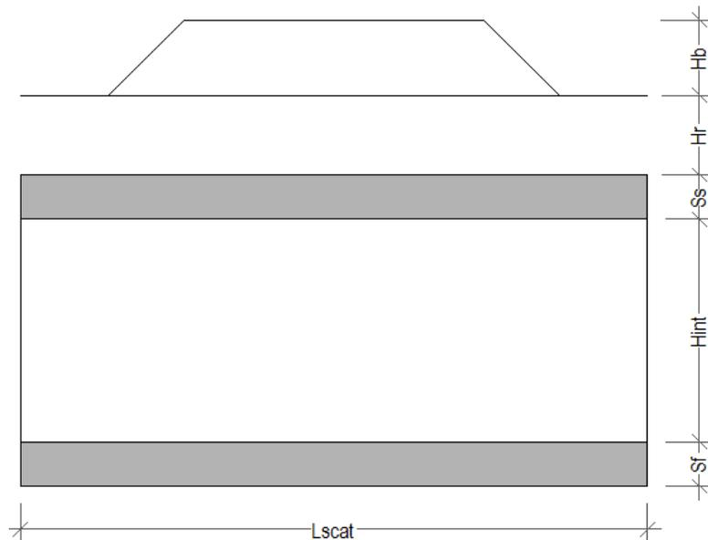
Figura 1. Sezione longitudinale dello scatolare
