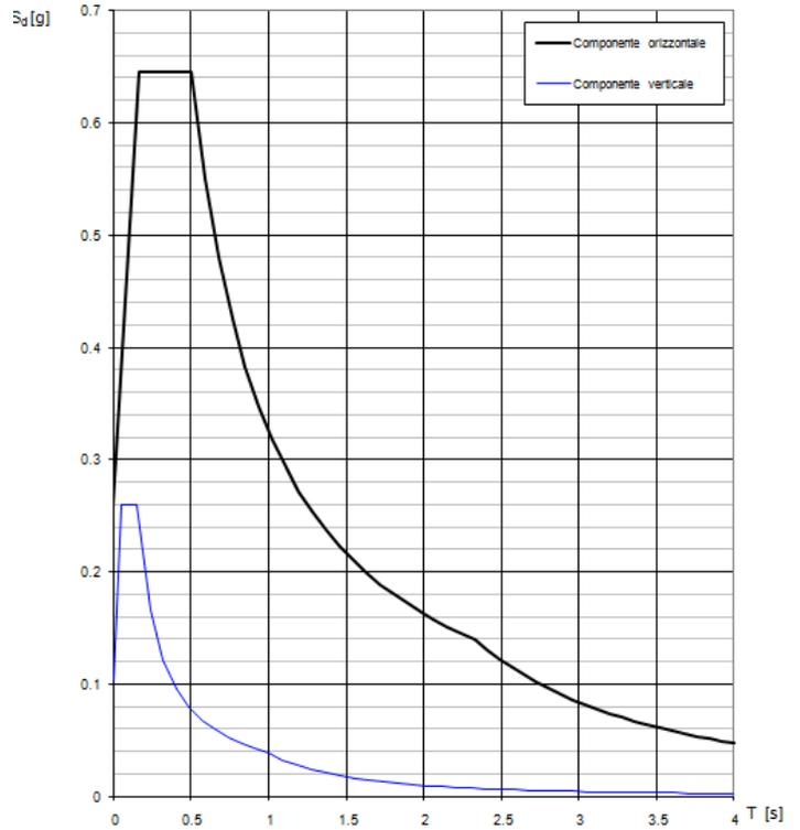
Il calcolo viene eseguito con il metodo pseudo statico, si eseguirà un calcolo elastico assumendo un fattore di struttura unitario. In queste condizioni l'azione sismica è rappresentata da una forza statica equivalente pari al prodotto delle forze di gravità per un opportuno coefficiente sismico.
