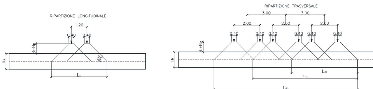
Il carico è schematizzato da due assi da 150 kN disposti ad interasse di 1.20m.
