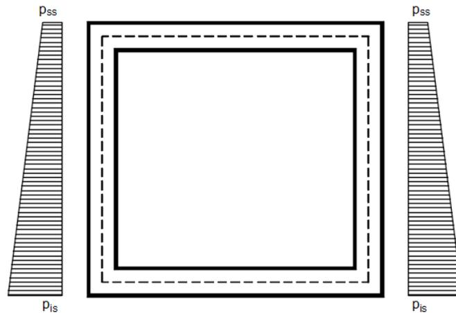
Per tenere in conto dei carichi agenti sul semispessore degli elementi considerati nel modello di calcolo, si applicano delle forze concentrate nei nodi tra piedritto e soletta superiore con valore pari a 4.32 kN ed inferiore con valore pari a 10.06 kN.
