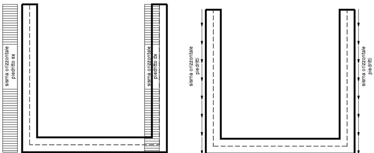
Per tenere in conto dei carichi agenti sul semispessore degli elementi considerati nel modello di calcolo, si applicano delle forze concentrate nei nodi tra piedritto e soletta inferiore con valore pari a 1.71 kN.
