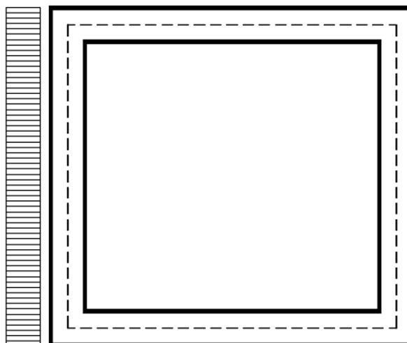
Per tenere in conto dei carichi agenti sul semispessore degli elementi considerati nel modello di calcolo, si applicano delle forze concentrate nei nodi tra piedritto sinistro e soletta superiore con valore pari a 1.28 kN ed inferiore con valore pari a 1.71 kN.
