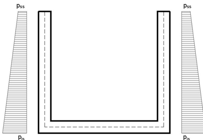
Per tenere in conto dei carichi agenti sul semispessore degli elementi considerati nel modello di calcolo, si applicano delle forze concentrate nei nodi tra piedritto e soletta inferiore con valore pari a 5.12 kN.
