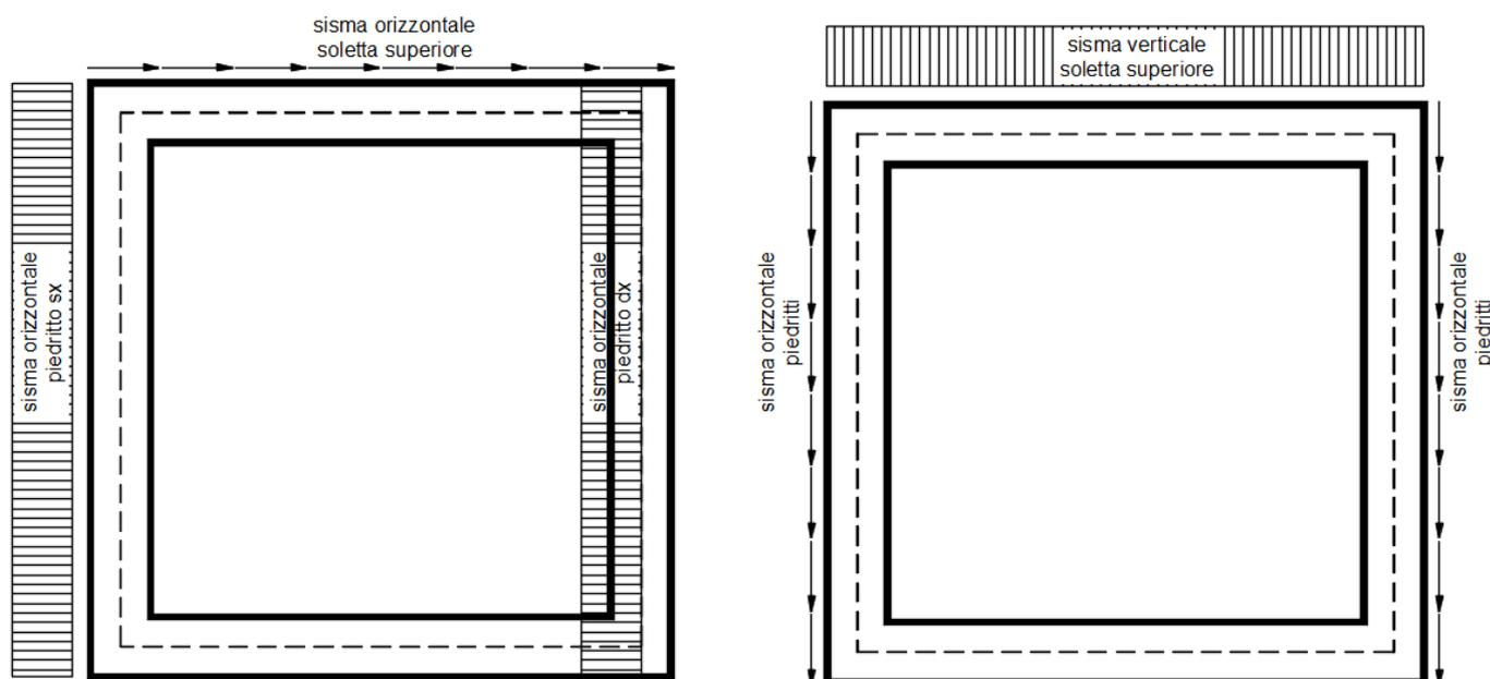
Per tenere in conto dei carichi agenti sul semispessore degli elementi considerati nel modello di calcolo, si applicano delle forze concentrate nei nodi tra piedritto e soletta superiore con valore pari a 1.28 kN ed inferiore con valore pari a 1.71 kN.
