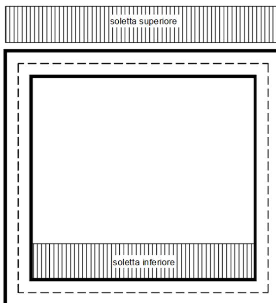
Per tenere in conto dei carichi agenti sul semispessore degli elementi considerati nel modello di calcolo, si applicano delle forze concentrate nei nodi tra soletta superiore e piedritti con valore pari a 0.45 kN.
