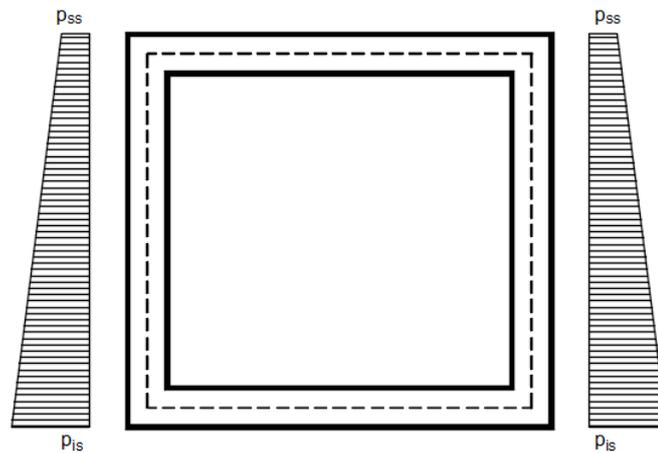
Per tenere in conto dei carichi agenti sul semispessore degli elementi considerati nel modello di calcolo, si applicano delle forze concentrate nei nodi tra piedritto e soletta superiore con valore pari a 0.29 kN ed inferiore con valore pari a 4.69 kN.
