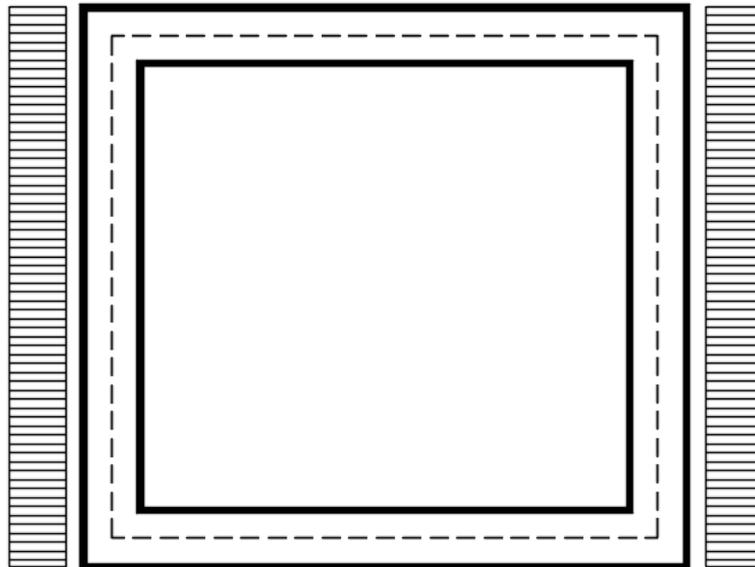
Per tenere in conto dei carichi agenti sul semispessore degli elementi considerati nel modello di calcolo, si applicano delle forze concentrate nei nodi tra piedritti e soletta superiore con valore pari a 1.28 kN ed inferiore con valore pari a 1.71 kN.
