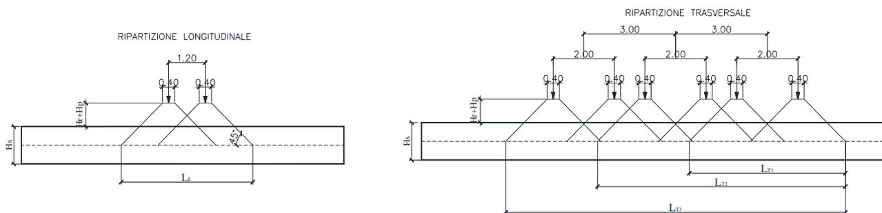
Il carico è schematizzato da due assi da 150 kN disposti ad interasse di 1.20m.
