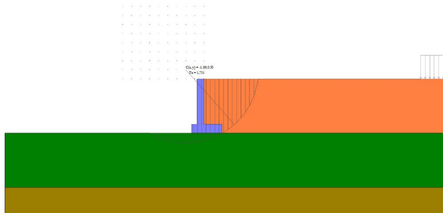
Figura 29 - Superficie di scivolamento critica
