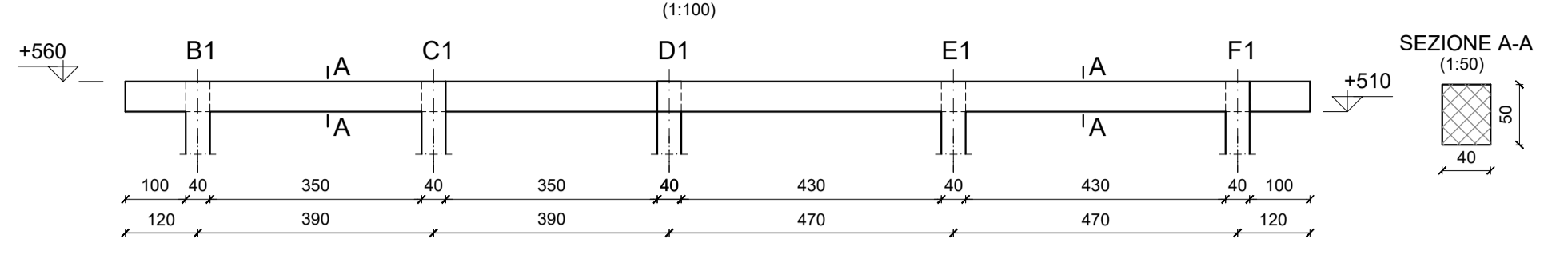
Trave di copertura Picc. 2
