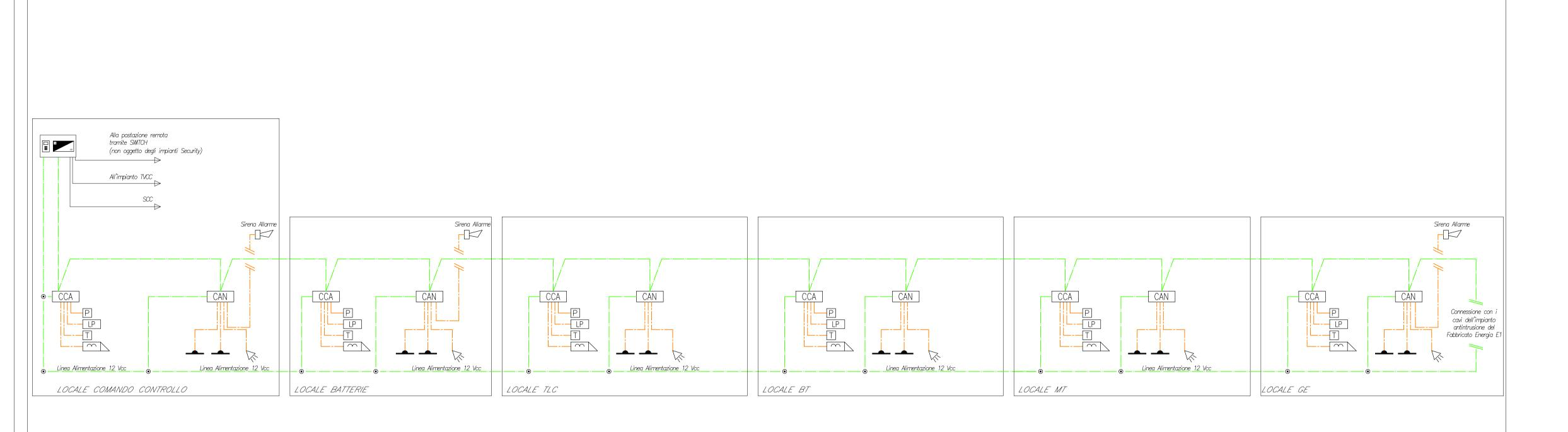
LEGENDA Elemento Descrizione Centrale antintrusione e controllo accessi Modulo combinatore telefonico installato a bordo Rilevatore a contatto magnetico Lettore di prossimità Elettroserratura Pulsante apriporta Tastierino alfanumerico Sensore volumetrico Sirena di allarme Sensore di rottura vetro Concentratore di Varco Concentratore di Varco Concentratore 1/0
