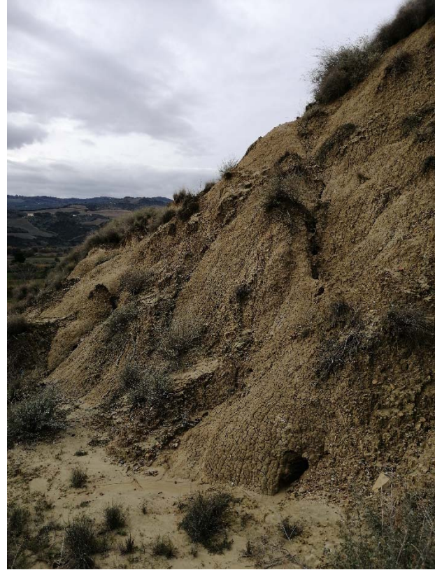
Figura 13-24 – Fessure trasversali di distensione osservate in corrispondenza degli stop 1, 2 e 3.
