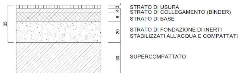
FIGURA 8 SCHEMA DELLA STRATIGRAFIA DELLA SEZIONE STRADALE TIPO
