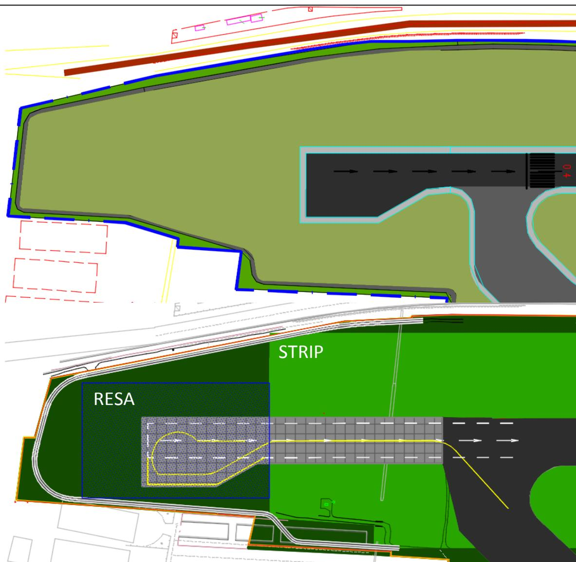
Figura 3 Confronto configurazione autorizzata dal DEC VIA (sopra) e di progetto (sotto)
