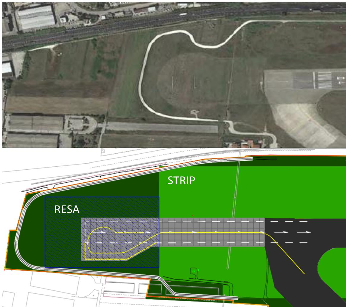
Figura 2 – Confronto configurazione attuale (sopra) e di progetto (sotto)
