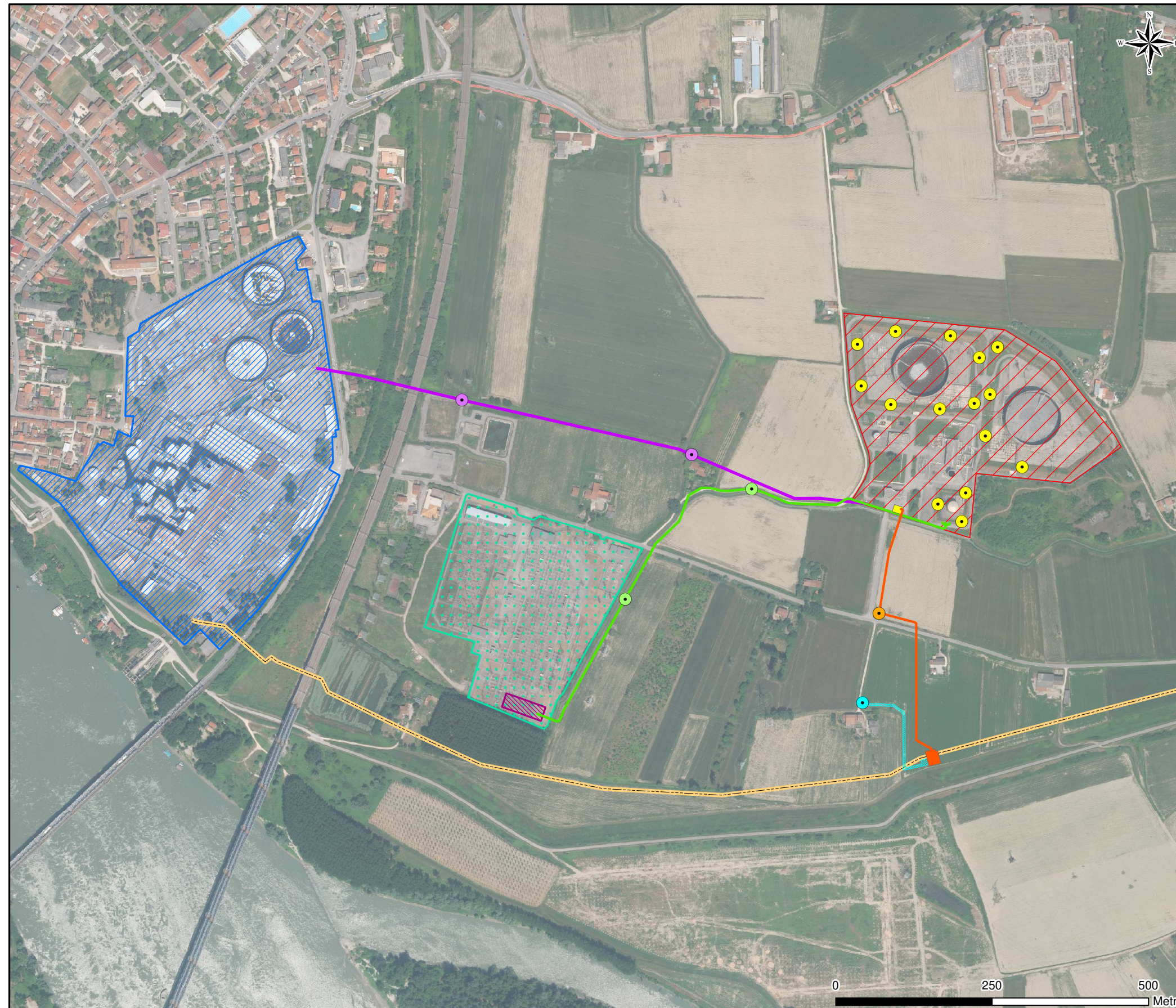
Figura 5a Ubicazione sondaggi proposti
