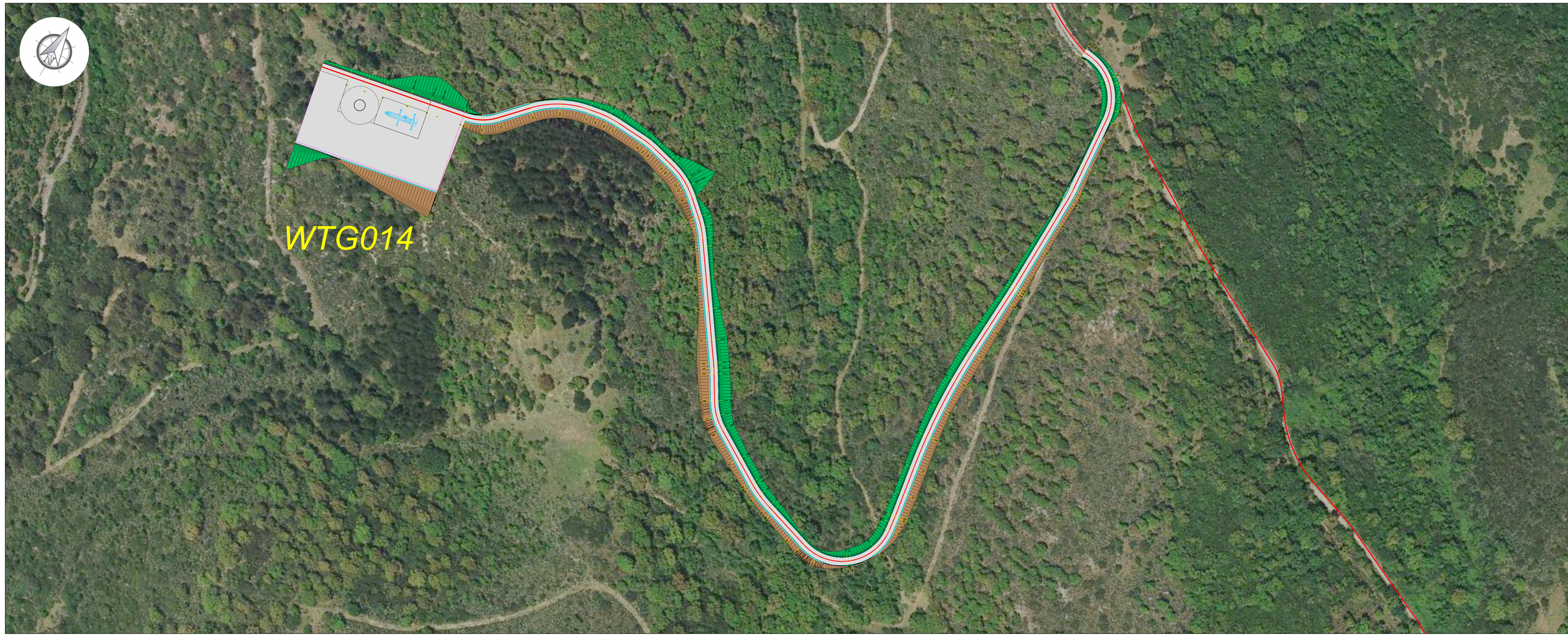
PLANIMETRIA VIABILITA' DI SERVIZIO AEROGENERATORE E RELATIVA PIAZZOLA Scala 1:1'000
