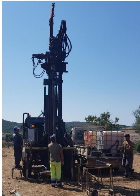
Figura 15.2 - Sonda idraulica Hydra mod. Joy3
