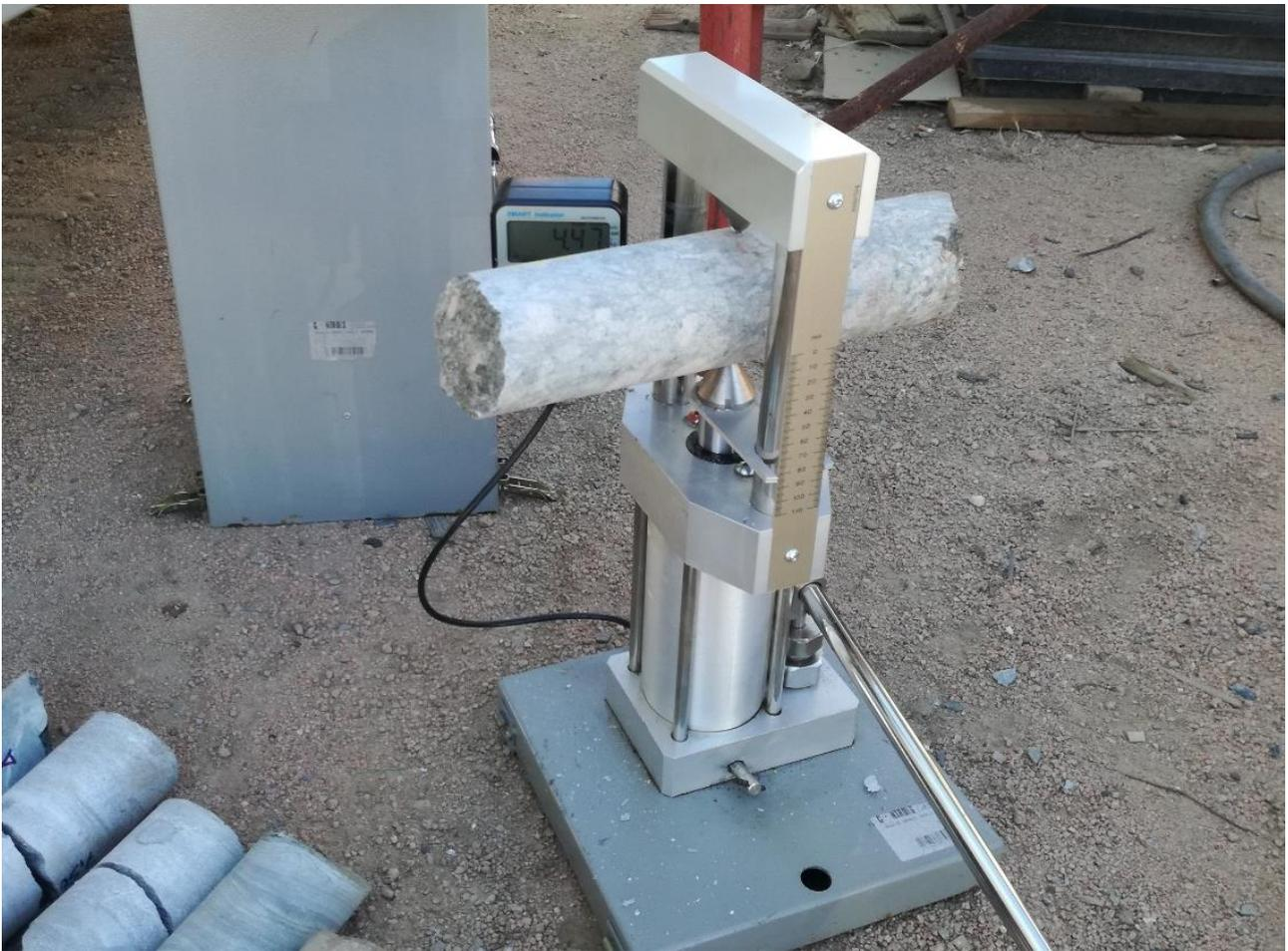
Figura 15.9 - Esecuzione delle prova Point Load
