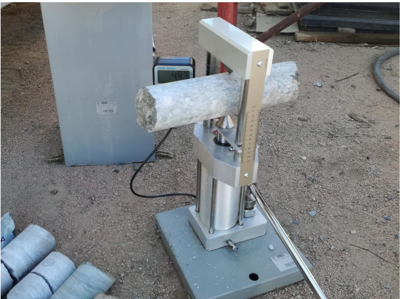
Figura 7.11 - Esecuzione delle prova Point Load
