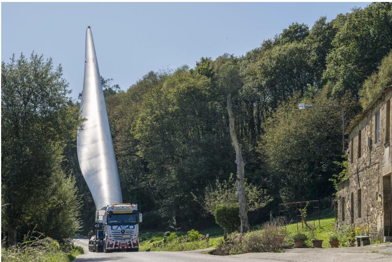
Figura 5: blade filter, utilizzato per il trasporto delle pale per aerogeneratori.
