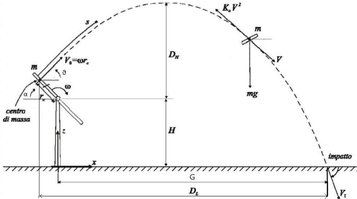
Scomponendo il moto della pala sugli assi orizzontale ( $x$ ) e verticale ( $y$ ), abbiamo sulla prima un moto uniforme, e sulla seconda un moto rettilineo uniformemente accelerato dalla gravità:
