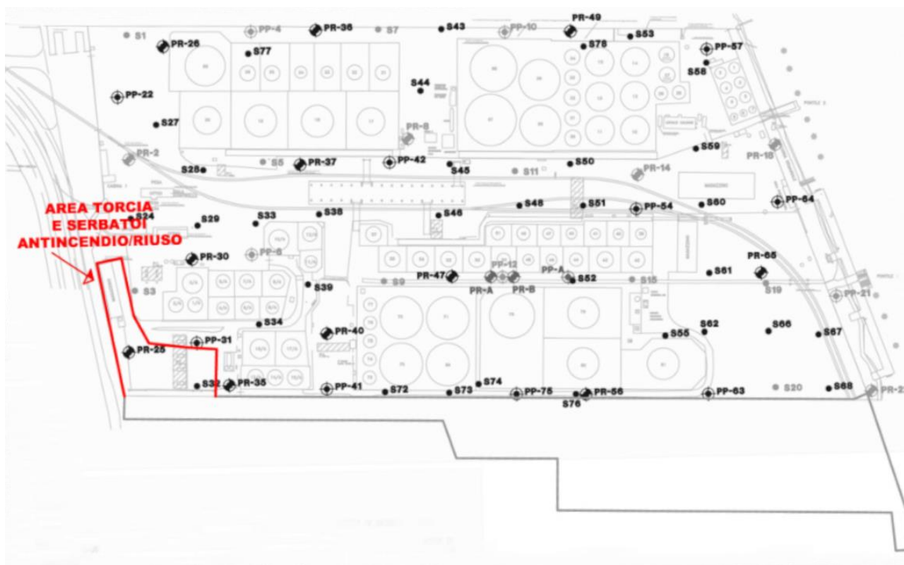
Fig. 3.4 – Ubicazione dei Punti di Indagine di Suolo e Sottosuolo (Caratterizzazione 2004/2005). (v. Doc. 12)
