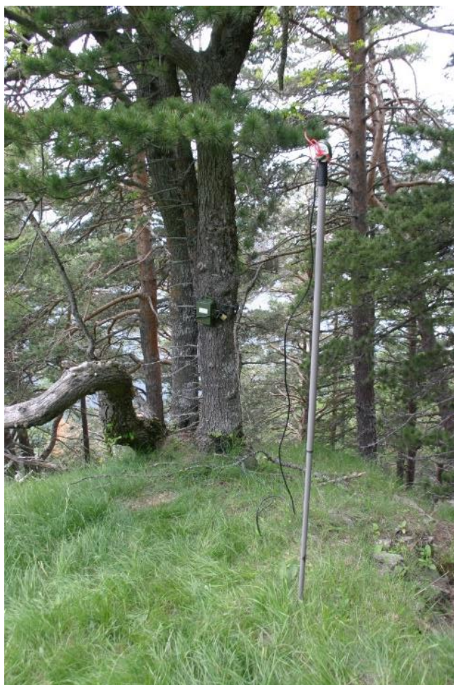
Figura 2. Bat detector Wildlife Acoustics Song Meter SM4BAT FS Ultrasonic Recorder fissato ad un albero e collegato a un microfono SMM-U2 External Ultrasonic Microphone posto a circa 2 m da terra (foto Sandro Bertolino).
