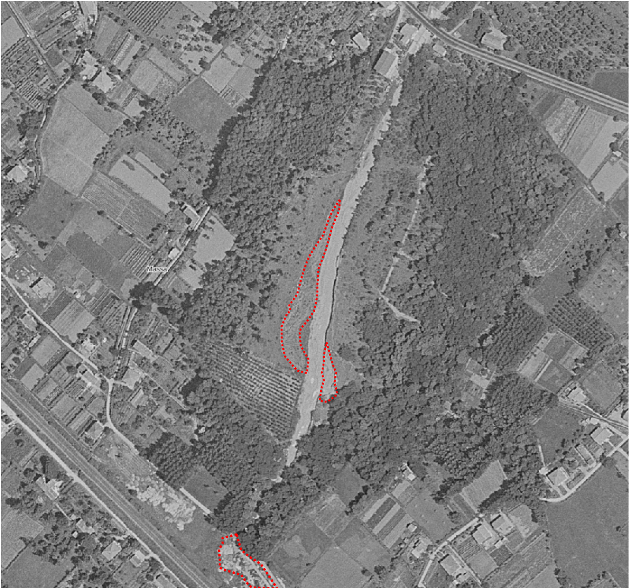
Fig. 4.6. Canal Magro nel tratto compreso tra la SS1 Aurelia e la ferrovia, evidenziati gli alvei di divagazione delle esondazioni. Immagine OFC 10K del 1965 ( http://www502.regione.toscana.it/geoscopio/fototeca.html ).
