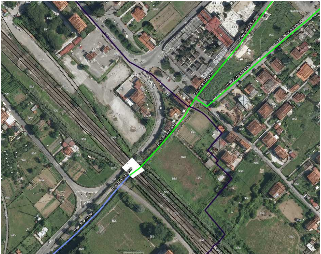
Fig. 4.2. Fosso Magliano. In verde il tratto tombato, in blu il tratto non tombato a valle della ferrovia ( https://geoportale.lamma.rete.toscana.it/difesa_suolo/#/viewer/openlayers/265 )
