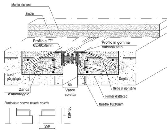
DETTAGLIO STRATI PAVIMENTAZIONE SU IMPALCATO
