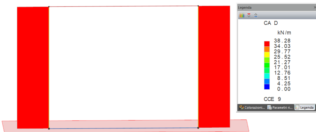
Figura 16 – Modello di calcolo: CCE 9: incremento sismico q_1 = 0.258 \cdot 20 \cdot 7.42 = 38.28 \text{ kN/m} ,
