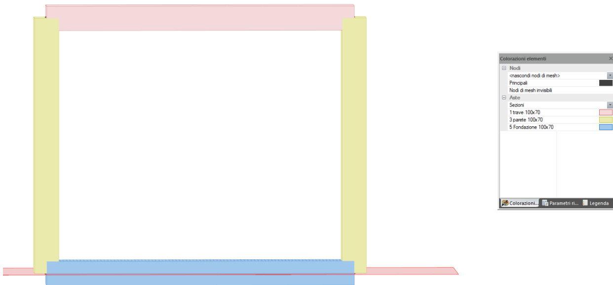
Figura 7 – Modello di calcolo: luce massima canna stradale in asse manufatto:8.95mt
