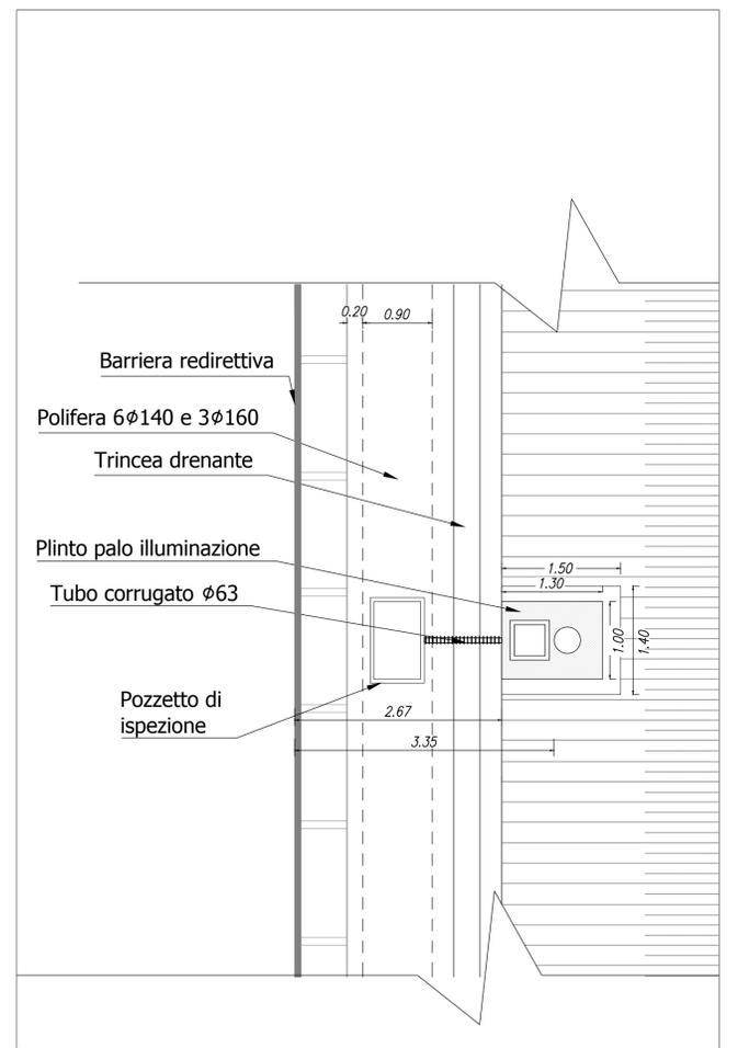
DERIVAZIONE AL CORPO ILLUMINANTE DA POZZETTO - STRALCIO SEZIONE TIPO 1
