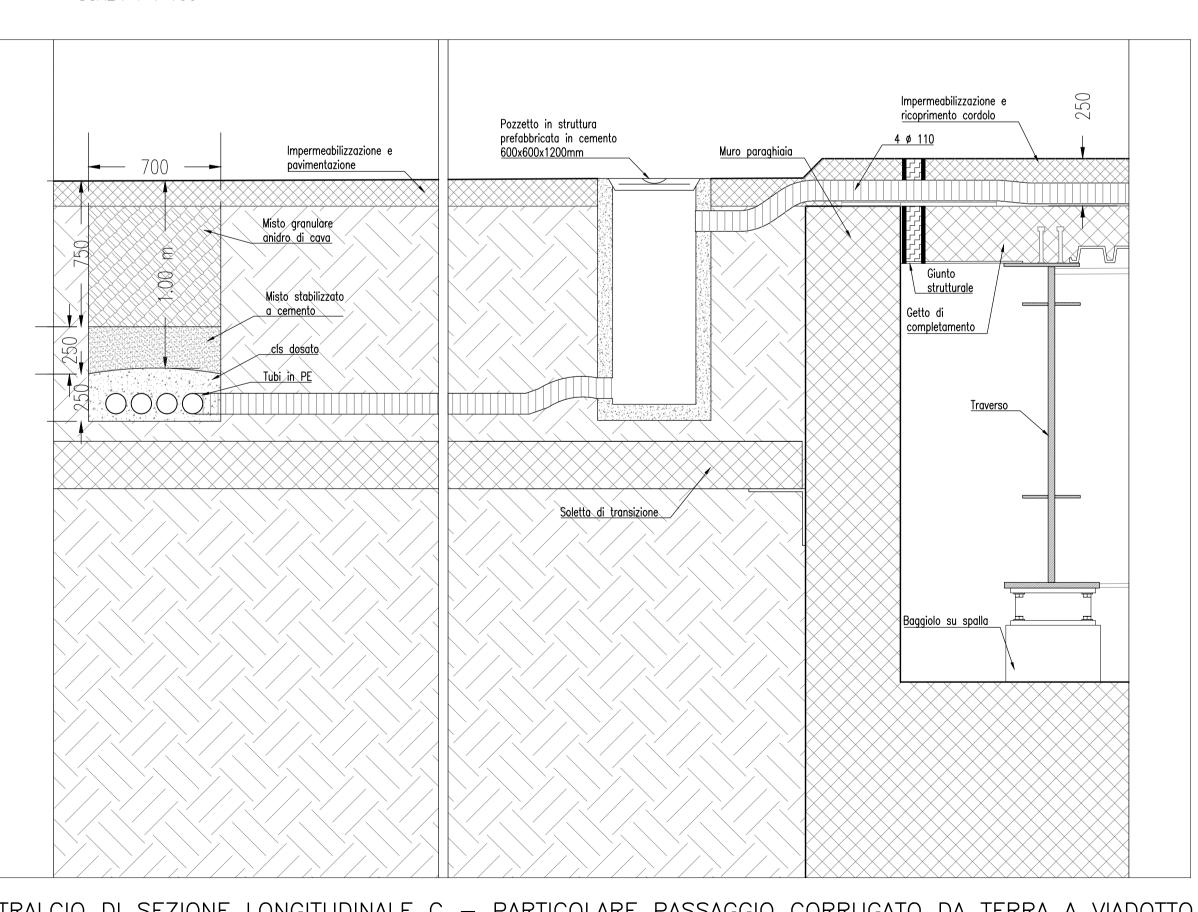
STRALCIO DI SEZIONE LONGITUDINALE C - PARTICOLARE PASSAGGIO CORRUGATO DA TERRA A VIADOTTO
