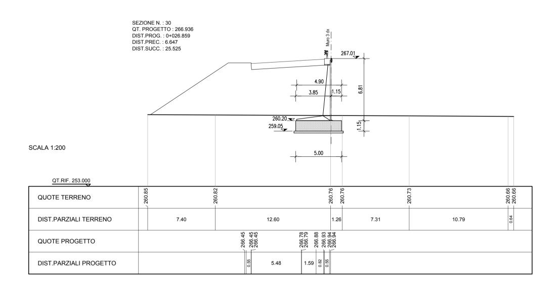
SEZIONE TRASVERSALE — Scala 1:200 SEZIONE 31 — MURO DX — PROGR. 0+052,384
