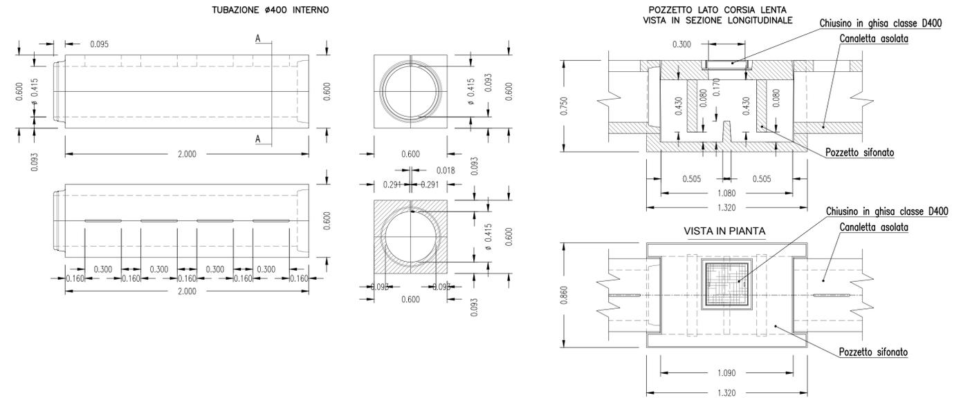
**POZZETTO IN CALCESTRUZZO PER COLLEGAMENTO CANALETTA ASOLATA - COLLETTORE PRINCIPALE**
