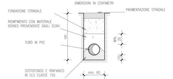
**SEZIONE TIPO DI POSA PER TUBAZIONI IN C.A. E PEAD**
