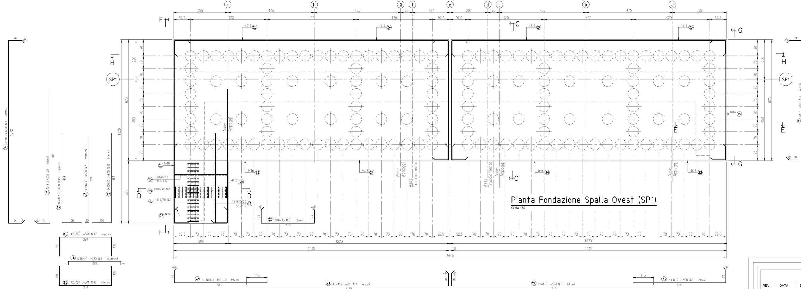
**Pianta Fondazione Spalla Ovest (SP1)**
