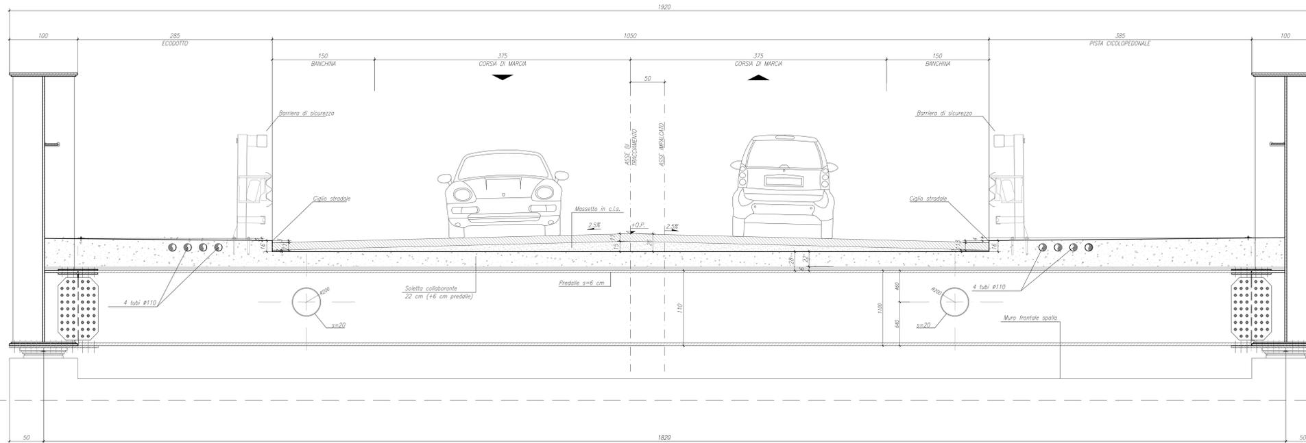
SEZIONE TRASVERSALE IN ASSE APPOGGIO
