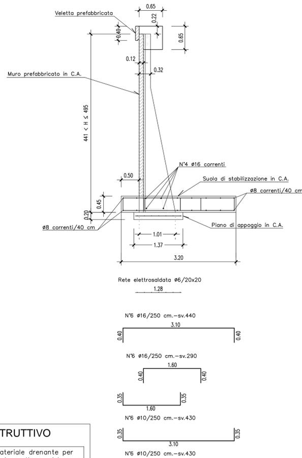
**SEZIONE "D" MURO PREFABBRICATO**
