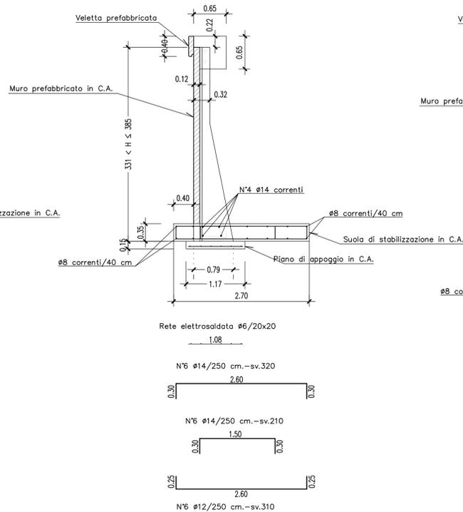
**SEZIONE "D" MURO PREFABBRICATO**
