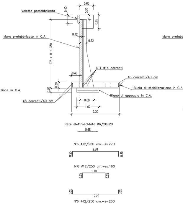
**SEZIONE "C" MURO PREFABBRICATO**
